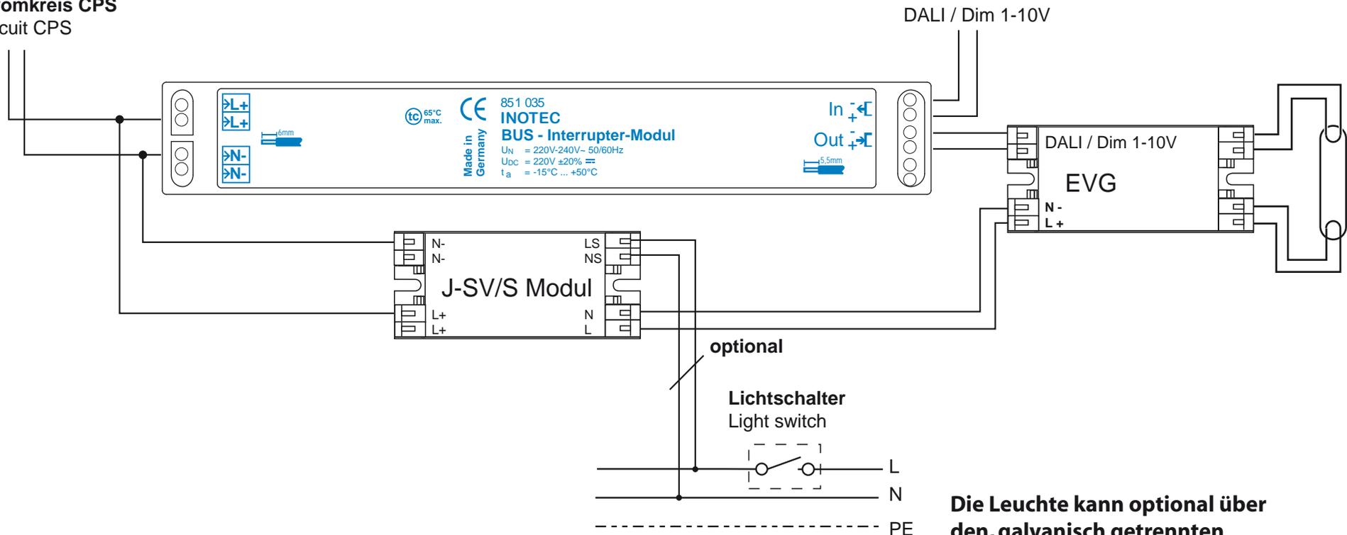
**Die Dimmung bzw. das DALI-Signal wird bei Joker- oder Batteriespannung unterbrochen.**
